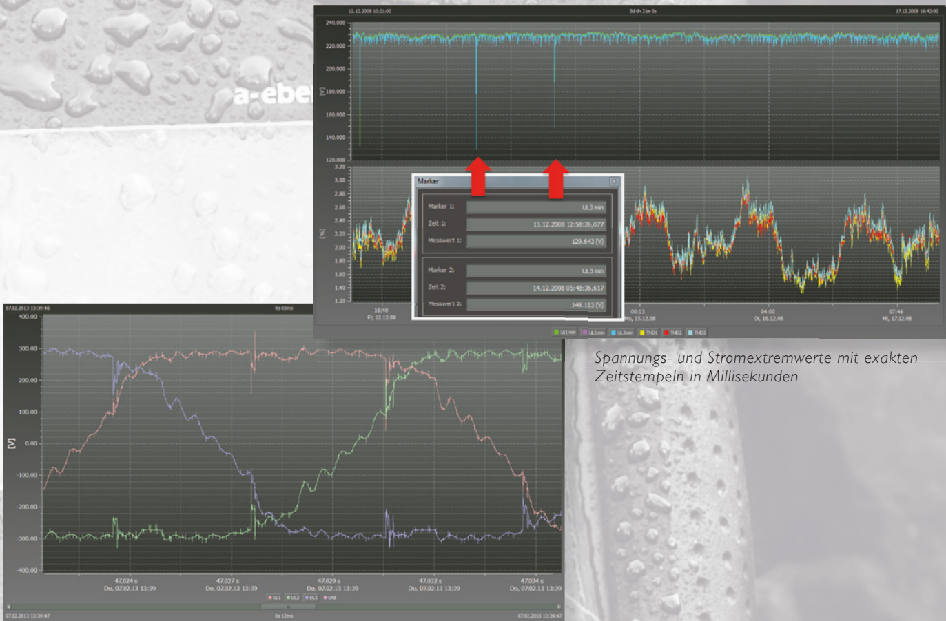
Oszilloskoprekorder – Extrem hohe Auflösung durch die Verwendung von 24-bit Eingangswandlern für alle Spannungs- und Stromkanäle
